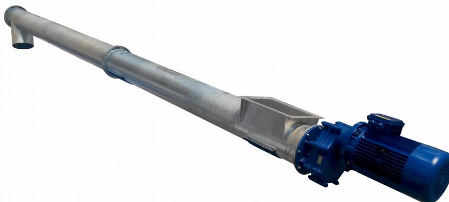
Применяются для транспортировки пылевидных, порошкообразных и реже мелкокусковых насыпных грузов на сравнительно небольшое расстояние (обычно до 40 м по горизонтали и до 30 м по вертикали) при производительности обычно до 100т/ч. К преимуществам винтовых конвейеров относятся простота устройства и несложность технического обслуживания, небольшие габаритные размеры, удобство промежуточной разгрузки, герметичность, что особенно важно при перемещении пылящих, горячих и остропахнущих грузов.
