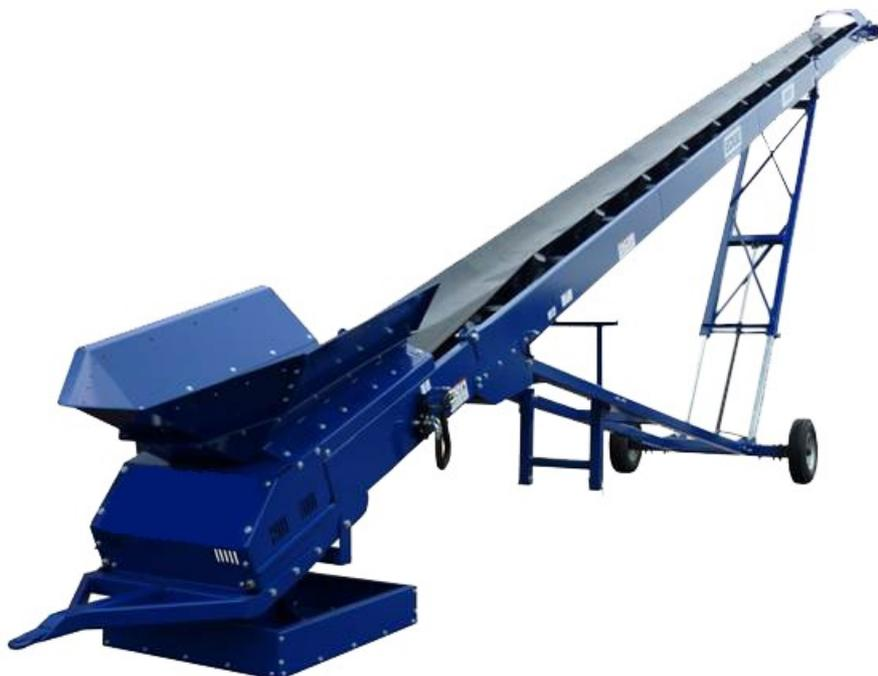
**Поворотный ленточный конвейер** используется практически на любом производстве пищевой промышленности, так как позволяет правильно организовать конвейерные системы и логистические пути.
