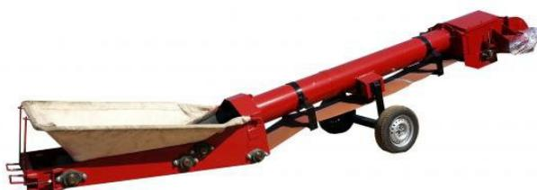
Разгрузчик вагонов предназначен для выгрузки цемента, шрота, зерна и других сыпучих продуктов из вагона-хоппера.
