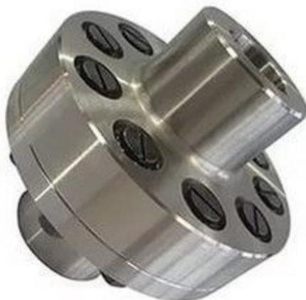
**Муфта упругая втулочно-пальцевая (МУВП)** — упругая муфта, для компенсации динамических нагрузок. Состоит из двух полумуфт, неподвижно закреплённых в одной полумуфте пальцев, на которых размещены резиновые втулки, через которые пальцы взаимодействуют с другой полумуфтой.
