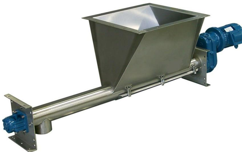
**Винтовые (шнековые) питатели** представляют собой аппараты, в которых груз перемещается волочением по неподвижному желобу вращающимися лопастями винта. Питатели предназначены для выпуска из бункера и подачи сыпучих продуктов в различные технологические аппараты: весовые дозаторы, смесители, промежуточные емкости и т.д. Винтовой питатель (шнек) занимает прочное место во многих отраслях промышленности благодаря простой конструкции, компактности и экономичности.
