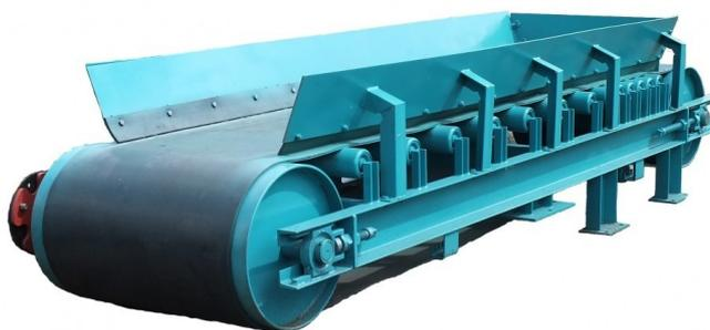
Ленточные питатели предназначены для регулирования подачи сыпучих продуктов. Равномерная выгрузка необходима при подаче продукта из бункеров или других накопительных емкостей на транспорт непрерывного действия: на ленточные конвейеры, к дробилкам, грохотам, мельницам, на сортировочные установки и др. Питатель может быть использован в качестве питателя объемного дозирования.
