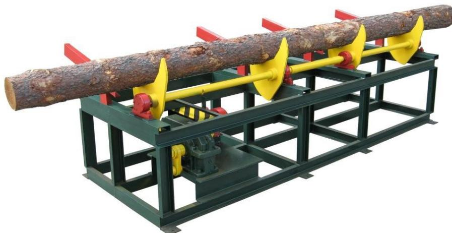
Механизм поштучной выдачи брёвен обеспечивает прием, накопление (3-4 шт.) бревен и их плавную безударную выдачу на подающие механизмы дисковых пилорам и любые другие механизмы переработки древесины, перемещение и сортировку пиловочника
