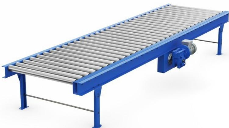
Приводные рольганги незаменимы на тех участках производства, где можно обойтись без участия человека. Особенностью таких конвейеров (рольгангов) является наличие мотор-редуктора, который приводит в движение ролики, а они, в свою очередь, двигают мелко и крупногабаритные штучные грузы (короба, ящики, паллеты и др). Приводные рольганги способны перемещать грузы под небольшим углом и дают возможность поддерживать спокойное и равномерное движение.
