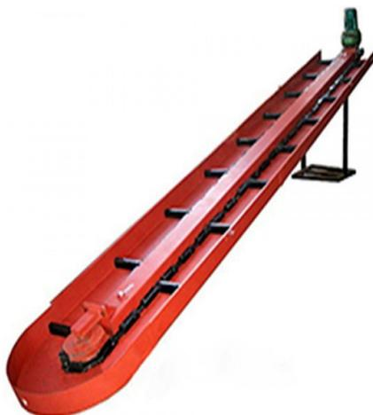
Для транспортировки различного материала в производственном и других помещениях часто проводится установка конвейеров. Подобное транспортное устройство непрерывного действия выпускается в самых различных вариантах исполнения, довольно большое распространение получили механизмы скребкового типа. Они характеризуются своими определенными свойствами, к примеру, перемещение материала проводится за счет специальных скребков.
