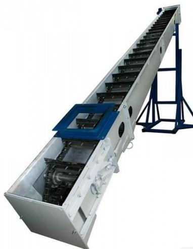
Для транспортировки различного материала в производственном и других помещениях часто проводится установка конвейеров. Подобное транспортное устройство непрерывного действия выпускается в самых различных вариантах исполнения, довольно большое распространение получили механизмы скребкового типа. Они характеризуются своими определенными свойствами, к примеру, перемещение материала проводится за счет специальных скребков.
