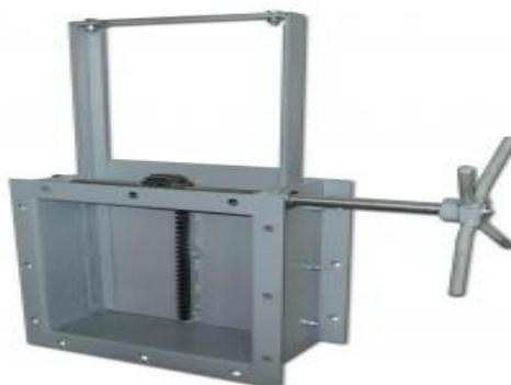
Шиберный (ножевой) затвор – параллельная задвижка, рабочий орган представляет собой стальной нож, по форме повторяющий сечение трубопровода. Шиберные задвижки предназначены для перекрытия и регулирования потока сыпучих материалов. Конструкция задвижки позволяет проводить открытие, закрытие и регулировку в рабочей среде.
