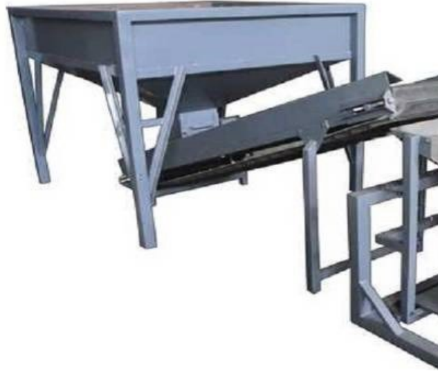
Растариватель биг-бэгов для ленточного конвейера
